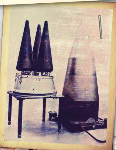
Gefechtsköpfe W78 der ICBM Minuteman III; die Mehrfach-Wiedereintrittskörper (MIRV) gestatten die Auswahl separater Ziele
